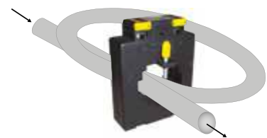
Äquivalent zu einem Wandler 100 / 5 A, I max = 50 A
